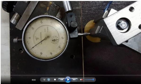
Fig. 23. Masurarea preciziei de repetabilitate (prima apasare pe palpatorul comparatorului cu cadran)
