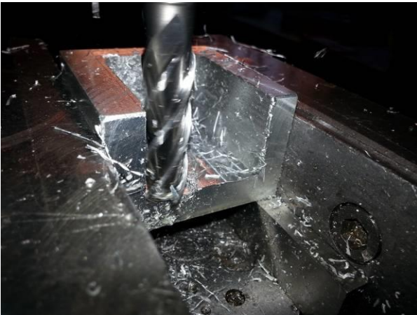
Fig. 8. Realizarea buzunarului pentru pinionul motorului.
