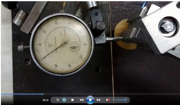
Fig. 24. Masurarea preciziei de repetabilitate (a 5-a apasare pe palpatorul comparatorului cu cadran)
