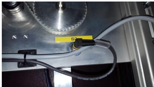
Fig. 20. Senzorul care confirmă poziția "0" a bratului 2
