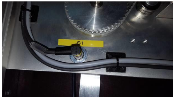
Fig. 19. Senzorul care confirmă poziția "0" a bratului 1
